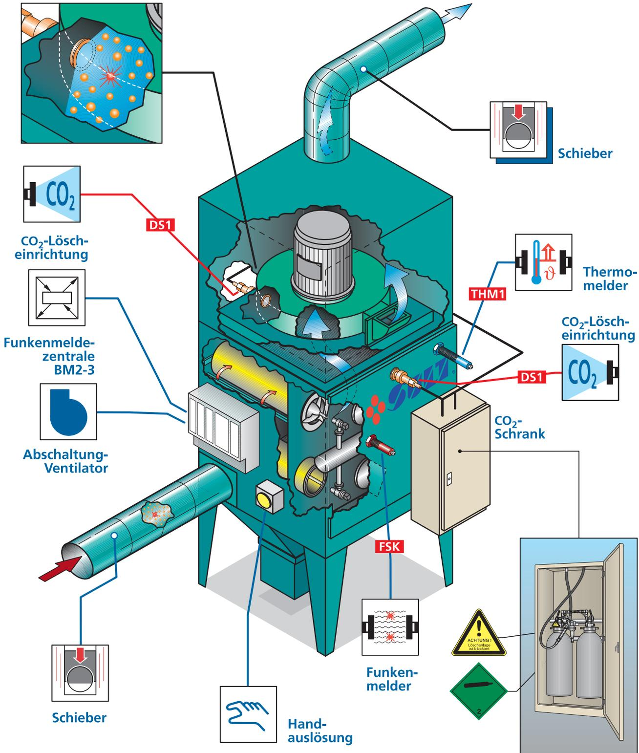
Schutz eines Patronenfilters durch eine Funkenlöschanlage mit CO<sub>2</sub>- oder Argon-Löscheinrichtung.
